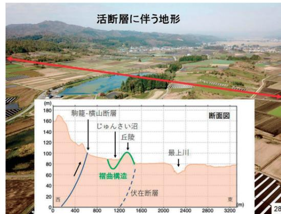
プレート運動（活断層）に伴い地形が変化している箇所が大石田町の近くに存在しています。村山市「じゅんさい沼」付近の様子です。地層が波のように曲がっています。（褶曲構造）
